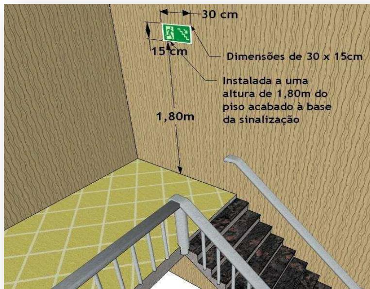
*Figura 44 - Sinalização de escada de emergência*
