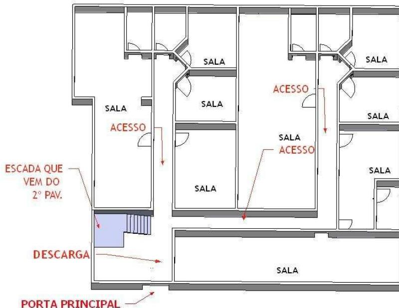
*Figura 18 - Componentes das saídas de emergência -*
