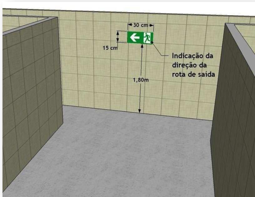
*Figura 42 - Indicação da direção da rota de saída*
