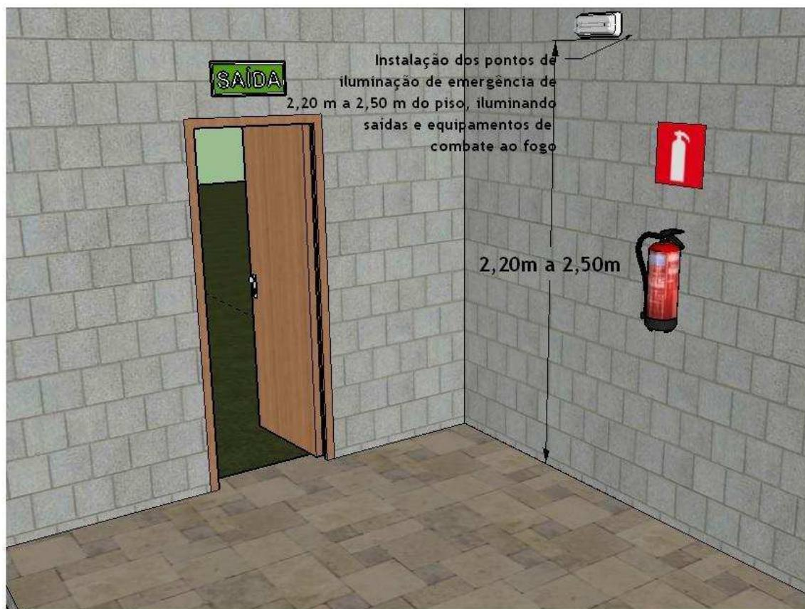
Figura 48 - Instalação dos pontos de iluminação de emergência
