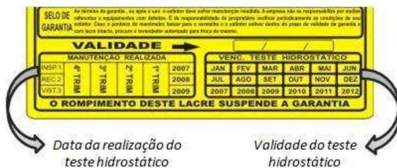
Figura 35 - Selo de garantia dos extintores de incêndio inspecionados
